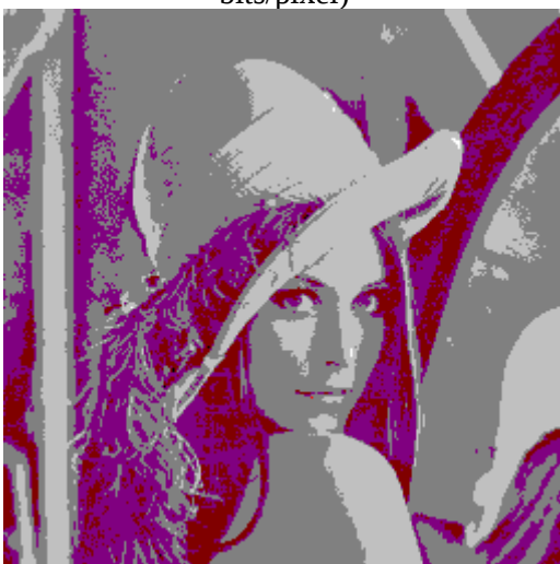
Fig. 3a: l-win-nn.tga (palette com 16 cores, 4 bits/pixel, palette padrão do windows, vizinho mais próximo).
