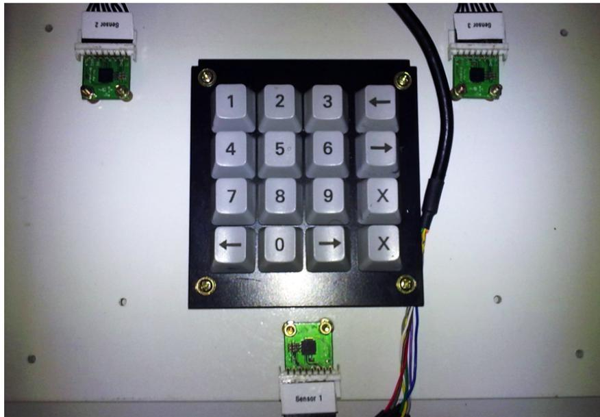
Figura 3.1: Montagem do teclado e disposição e posicionamento dos acelerômetros. A base é uma placa acrílica com 5mm de espessura.
