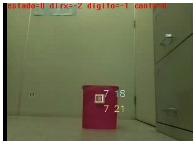
Figura 7: Estado 0 é o estado inicial do sistema. O carrinho procura placa e vai em sua direção.
