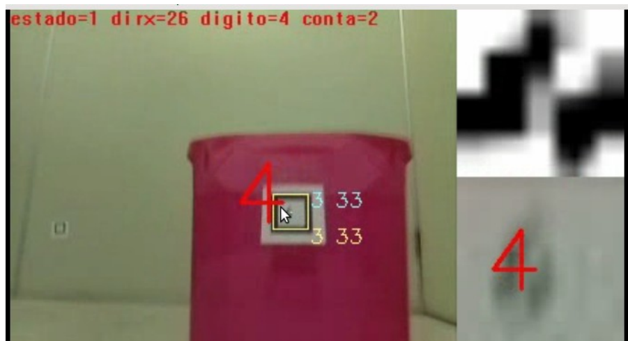
Figura 8: O sistema entra no estado 1 quando encontra placa suficientemente grande. O carrinho começa a parar.
