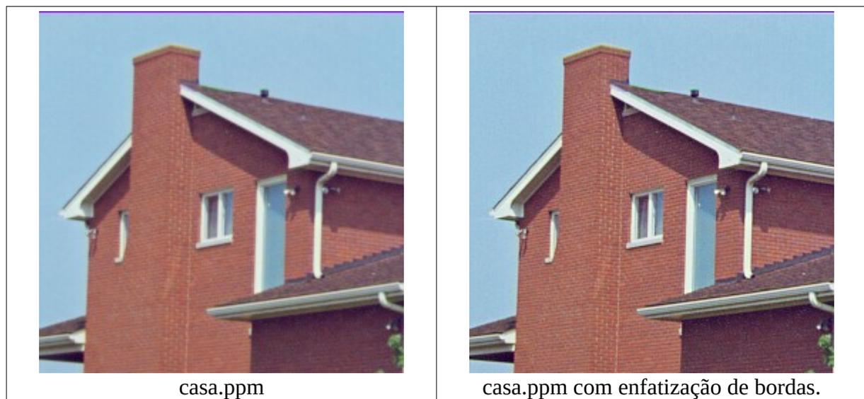
Figura F2: Enfatizando as bordas de uma imagem colorida, obtemos uma imagem que parece mais nítida que a original.
