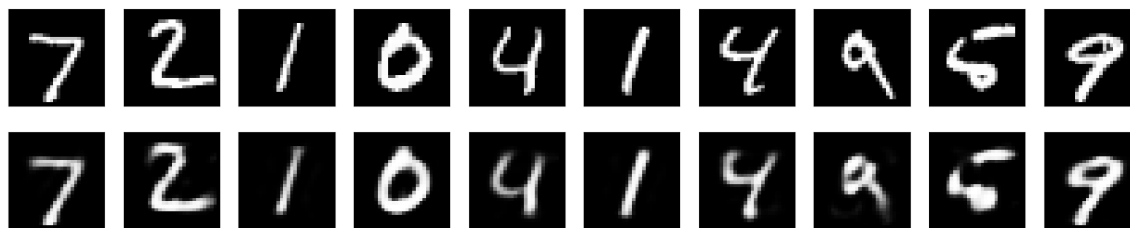
Figura 6: Linha superior: imagens originais. Linha inferior: imagens reconstruídos pelo autoencoder P3 com regularização de atividade L_1 .
