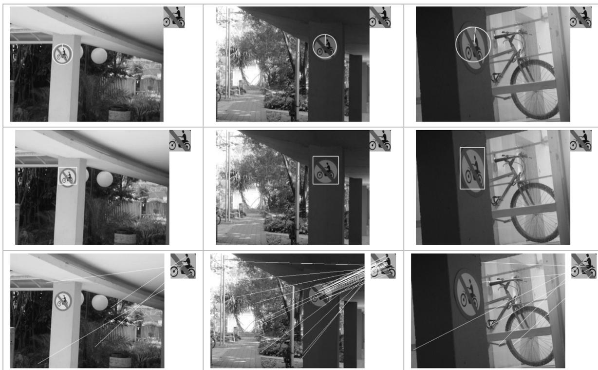
Fig. 5-9. Exemplo dos resultados da invariância a mudanças de brilho/contraste. De cima para baixo: Aciratefi, Aforapro e Asift. Aciratefi e Aforapro acertam todos os 3 testes, enquanto que Asift acerta apenas 1 dos 3 (exemplo 2), com mais de 3 casamentos corretos de pontos-chaves.
