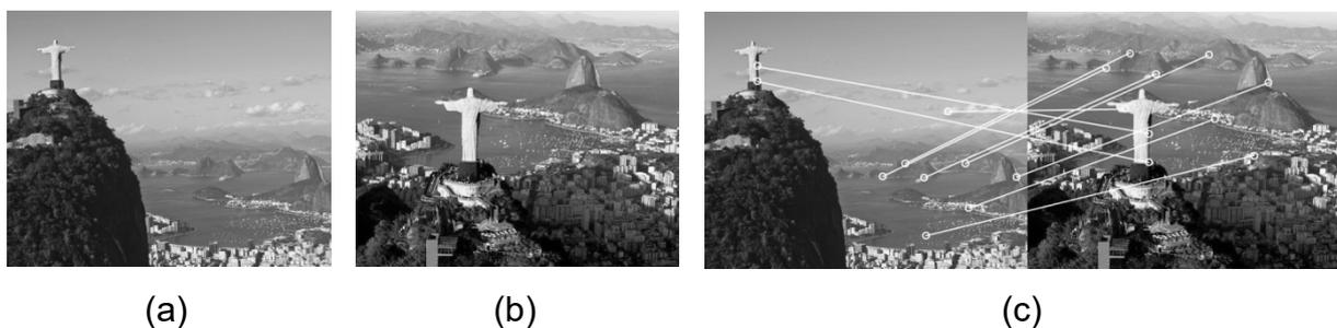
Fig. 2-1. Exemplo do casamento de pontos-chaves (a) Imagem  $I_1$ , (b) Imagem  $I_2$ , (c) Casamento, linhas indicando os pixels casados. Alguns destes casamentos apresentam falsas correspondências, devido talvez à variação da iluminação e/ou do ponto-de-vista.
