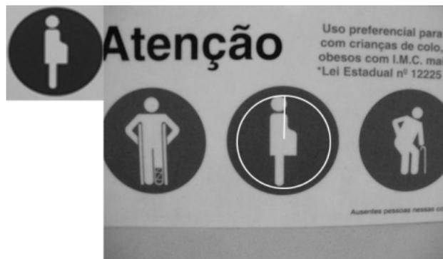
Fig. 3-9. Casamento de modelos por Ciratefi, etapa final (Tefi). O traço branco indica a instância da imagem  $Q$  achada. Neste caso, a posição de ponteiro indica rotação nula. O tamanho do círculo indica a escala aproximada na qual a instância foi achada.
