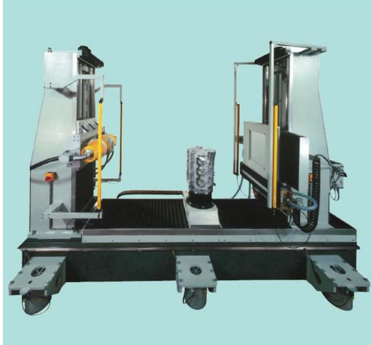
Figura 10 – Tomógrafo de bancada de 3ª geração para análise de peças, do web site da XYLON International X-ray GmbH [3].
