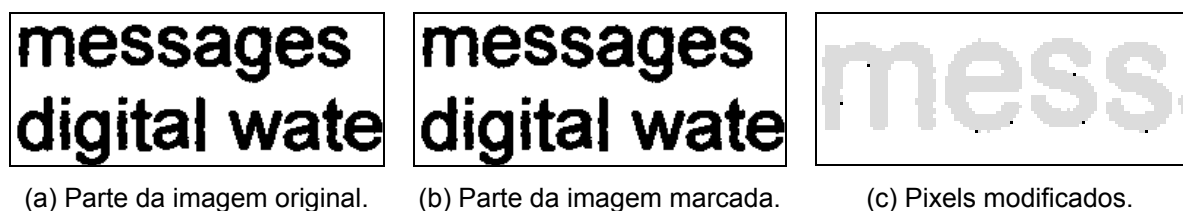
Figura 26 – Ampliação de uma imagem escaneada a 300 dpi, com 626×240 pixels, 93 instâncias de símbolos e 128 bits de informação inseridos pela DHCJT. (a) Parte da imagem original; (b) Imagem marcada; (c) Pixels modificados sobrepostos à imagem original (ampliação).
