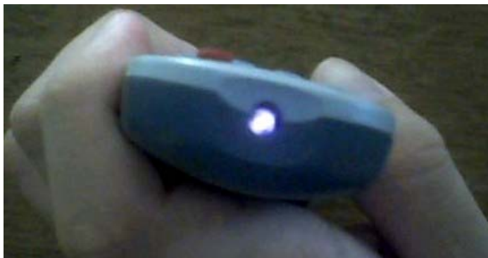
Figura 21 Efeito de LED infravermelho de controle remoto na imagem de uma webcam
