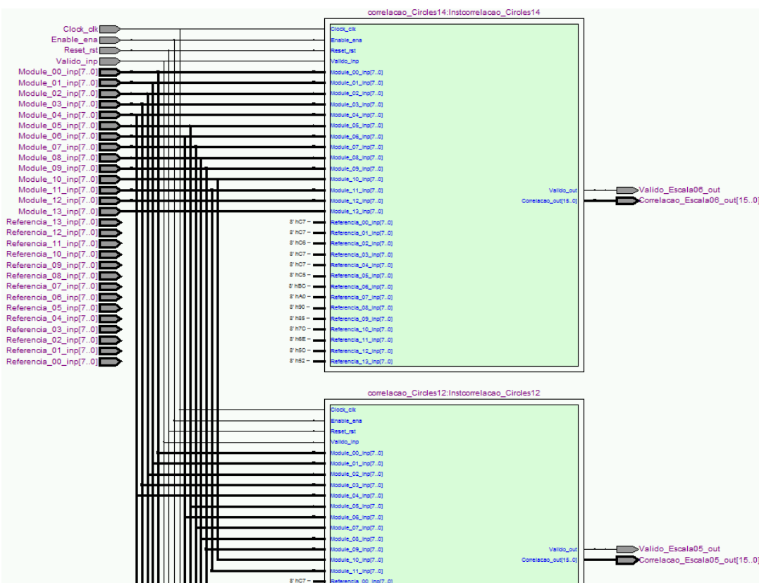
figura 71 Diagrama sintetizado em detalhe para os módulos de correlação com 14 e 12 círculos
