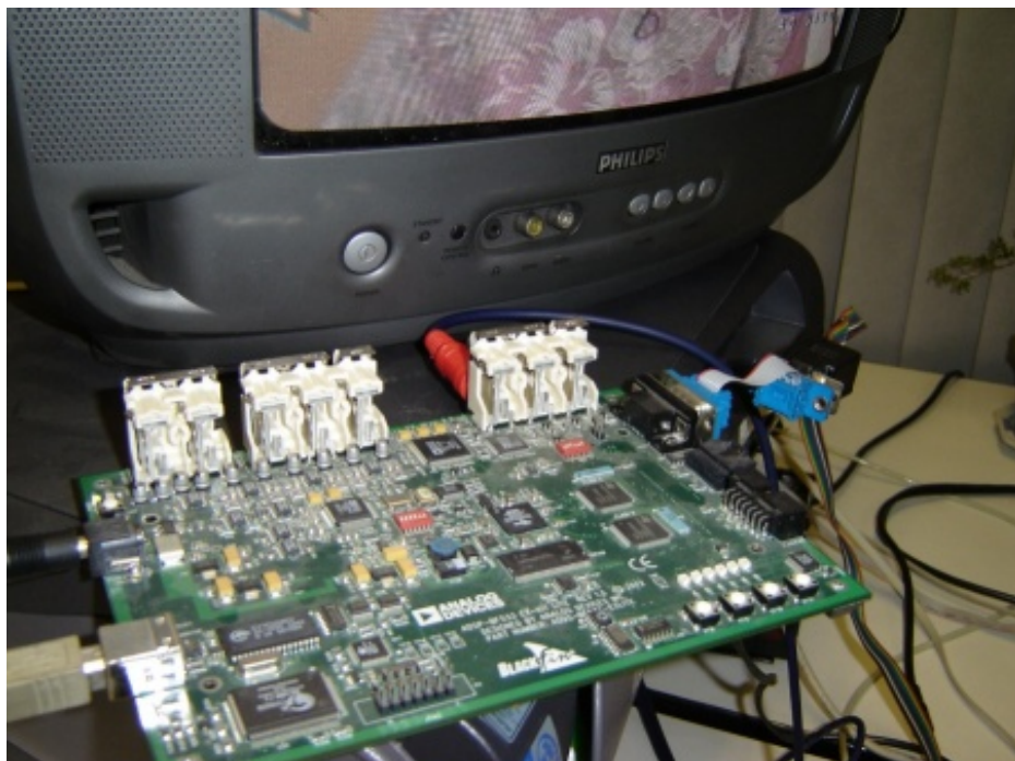
Figura 4.1 – Ilustração do ambiente de desenvolvimento composto de um televisor para geração do sinal PAL-M além da placa de desenvolvimento da Analog Devices EZ KIT LITE BF533.
