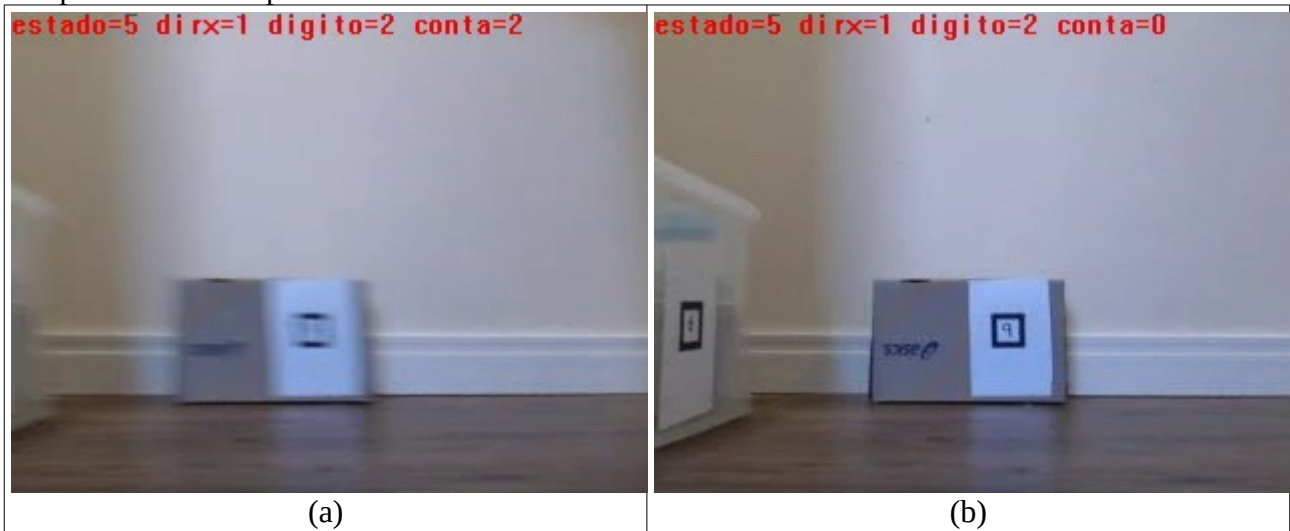
Figura 12: Estado 5 que para a movimentação do estado 3. A figura (a) está borrada, pois o carrinho ainda está girando por inércia, apesar dos motores terem parado. A figura (b) está nítida, pois o movimento de virar terminou.
