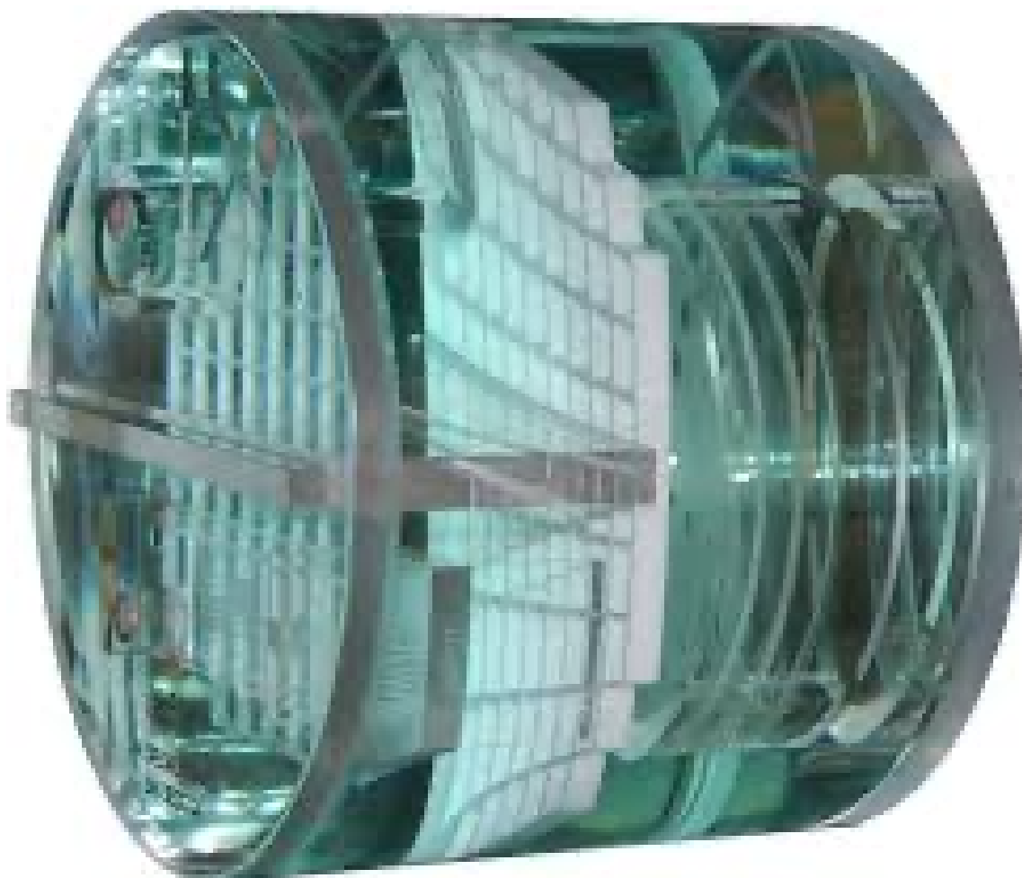
Figura 2: Exemplo de um phantom multipropósito com design recomendado pelo ACR.
