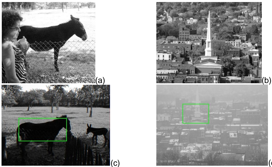
Figura 4.7 Testes comparativos, usando imagens que possuem mudanças de contraste testadas no capítulo anterior (Figura 3.15) onde o ASIFT não conseguiu reconhecer. (a-b) Imagem Q , (c-d) objeto reconhecido e rotulado pelo AFORAPRO, (c) efeito de sombra, (d) efeito de neblina.
